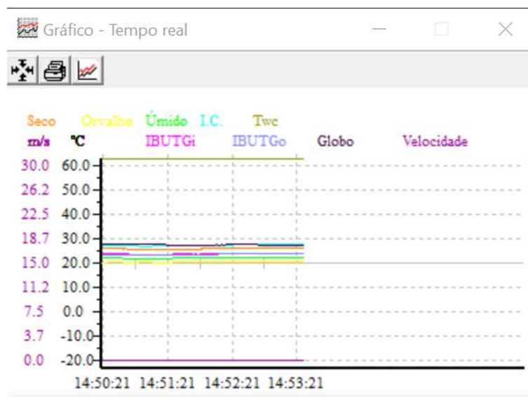
Gráfico evidenciando que o equipamento se estabilizou durante a avaliação de stress térmico.
