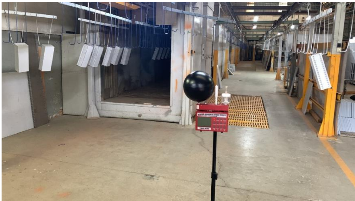
Foto do local da avaliação e do medidor de stress térmico.
